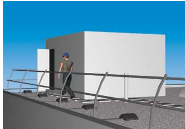
17 Flachdach mit Dachrandsicherung
