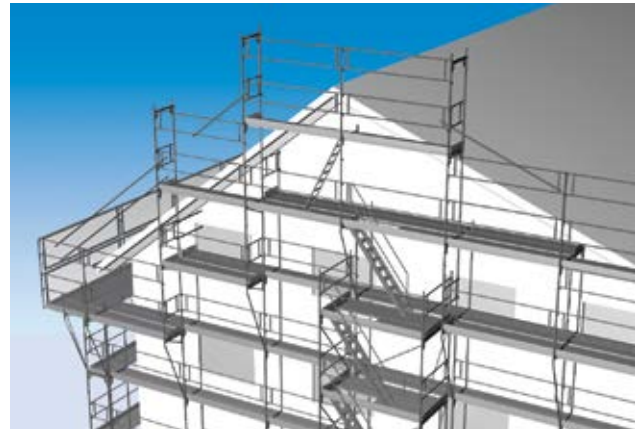
1 Kollektivschutz in der Bauphase
