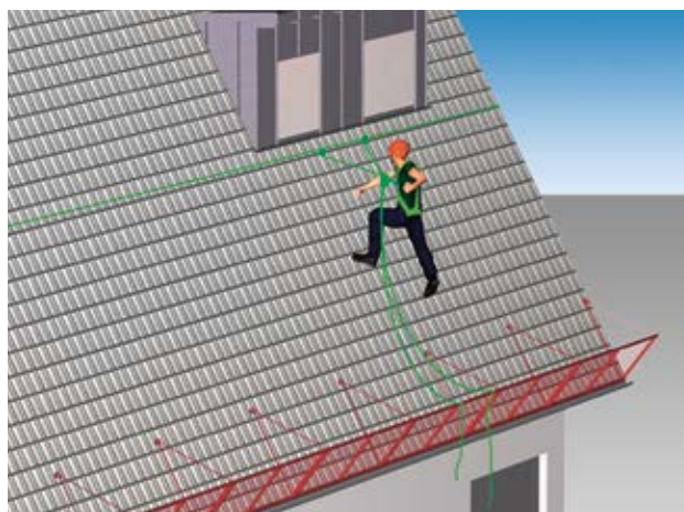
14 Arbeit am hängenden Seil. Als Zusatzmassnahme wurde eine Dachfangwand montiert, um herunterfallendes Material aufzufangen.
