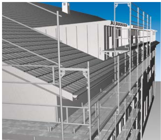
6 Das Fassadengerüst überragt den Dachrand der Gaube um mindestens 80 cm.
