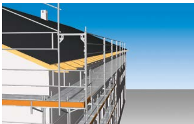
13 Lösung mit Innenkonsole am Gerüst. Sie verhindert, dass Personen zwischen Gerüst und Mauerwerk abstürzen.
